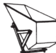
Sklopná (skipová) nádoba pro sklopný vozík - objem 80 lt
