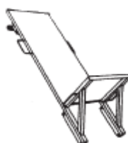
Sřešní vozík - vodorovná přeprava po sřešních latích
