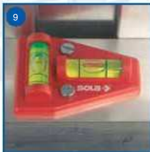
9 Křížová vodováha k vyrovnání kolmé polohy
