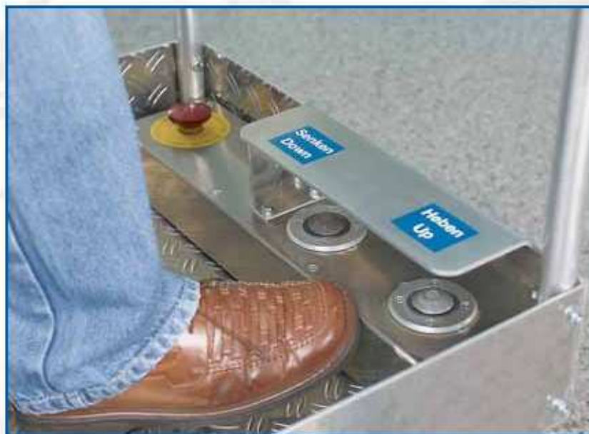
Nožní ovládání v koši pracovních plošin ALP-LIFT
