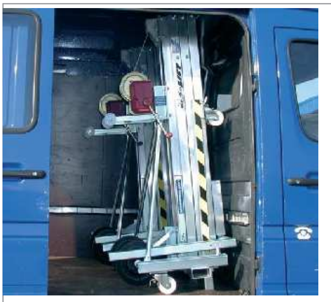
Typ LMC 380 – nosnost 250 kg, max. zdvih 3,8 m možnost přepravy ve svislé poloze
